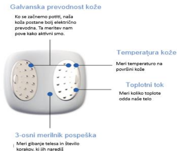
Slika 2: hrbtni del naprave s prikazom vgrajenih senzorjev
